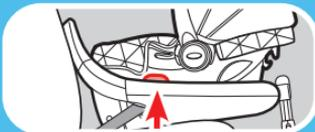
Con el automóvil nivelado con el piso verifique el indicador de nivel
