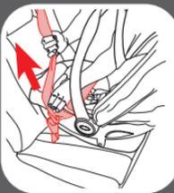
**Nota:** Con el cinturón de seguridad del vehículo en este modo trabado, toda la tensión está arriba en el cinturón de seguridad del vehículo para el hombro. Esto podría comenzar a inclinar el asiento de automóvil hacia el costado. Si ocurre, use una presilla de seguridad en lugar de trabar el retractor. Consulte la sección Placa de seguridad deslizante y retractor ELR.
