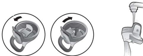
2° Trempez le couvercle dans de l'eau chaude savonneuse pendant dix minutes. Rincez et frottez la valve et le bec à l'aide d'une éponge et d'une brosse à poils pour enlever les résidus. Passez à l'étape 3 pour achever le processus de nettoyage.
