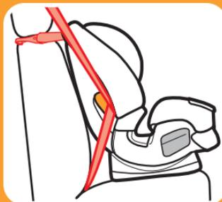
***Cinturón de seguridad para la falda y el hombro con correa del sistema de fijación***
