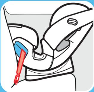
**Acoplamiento de anclaje inferior**
