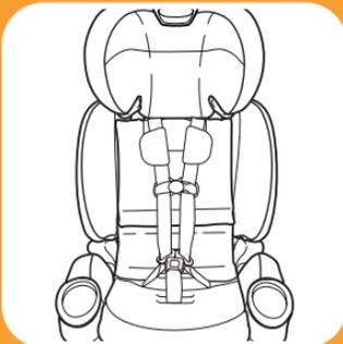
**12. Tensione la correa del sistema de fijación**
