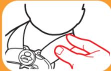
**El asiento de automóvil girado a la posición orientada hacia adelante no se mueve más de 1 pulgada (2.5 cm) en la vía del cinturón**
