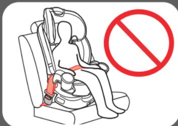
Este sistema de seguridad para niños está certificado para su uso en aeronaves solamente cuando se usa con el sistema de arnés interno en el modo orientado hacia adelante, y **SOLO** cuando se usa sin la traba SnugLock®.
