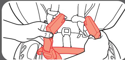
**4. Deslice toda la correa de anclaje inferior a lo largo de la barra roja hacia las aberturas deseadas de la vía del cinturón**
