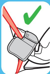
Al pasar el cinturón de seguridad del asiento del vehículo, asegúrese de que el cinturón del asiento no pase sobre el bolsillo de almacenamiento MyPocket™. Dele la vuelta al bolsillo y levántelo para sacarlo del medio cuando pase el cinturón de seguridad del vehículo.
