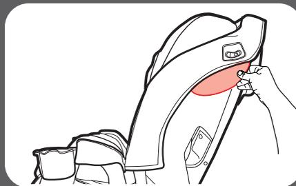
Sacar las correas elásticas de los ganchos al través del túnel del cinturón. Orientado hacia delante.
