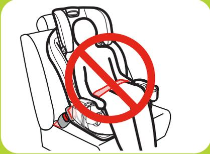
**Nunca use el cinturón de seguridad del vehículo solamente para la falda a través del frente del niño.**
