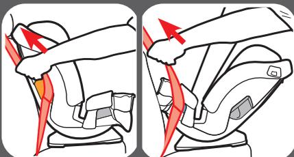
**Nota:** Con el cinturón de seguridad del vehículo en este modo trabado, toda la tensión está arriba en el cinturón de seguridad del vehículo para el hombro. Esto podría comenzar a inclinar el asiento de automóvil hacia el costado cuando orientado hacia atrás. Si ocurre, use una presilla de seguridad en lugar de este movimiento del retractor. Consulte la sección Placa de seguridad deslizante y retractor ELR.
