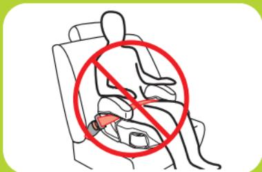
***Nunca use el cinturón de seguridad del vehículo solamente para la falda a través del frente del niño***
