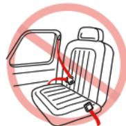
Cinturón para la falda o cinturón de seguridad del vehículo para el hombro montado en la puerta
