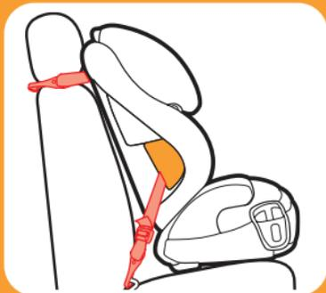
**Correa Correa del LATCH con el anclaje de sujeción**
