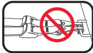
**! No conecte nunca dos conectores del LATCH a un barra de anclaje inferior del vehículo a menos que el fabricante del vehículo lo especifique.**
