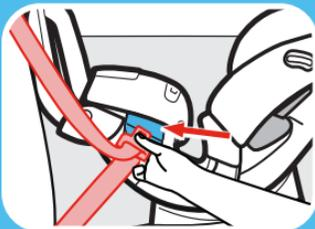
**11. Pase el cinturón de seguridad del vehículo debajo de la traba SnugLock®**
