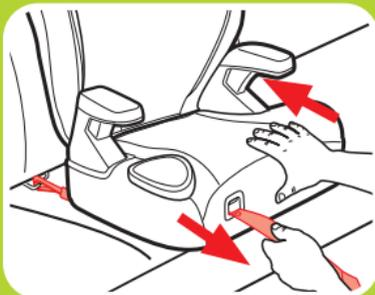
**3. Sujete los conectores de los anclajes inferiores a los anclajes inferiores de los anclajes inferiores del vehículo.**
