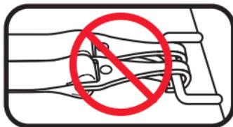
**! No conecte nunca dos conectores de los anclajes inferiores a un barra de anclaje inferior del vehículo a menos que el fabricante del vehículo lo especifique.**
