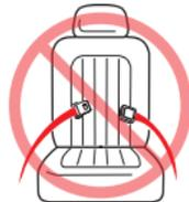
Cinturón para la falda solamente Dos puntos de conexión.
