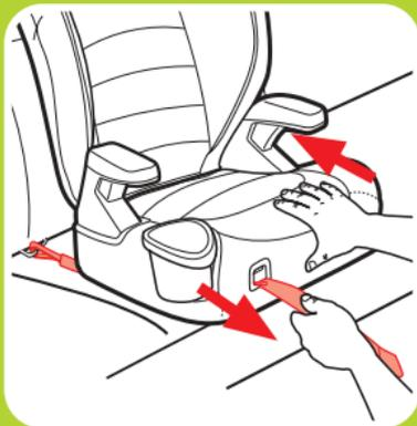
**3. Sujete los acoplamiento de anclaje inferior a los anclajes inferiores de los anclajes inferiores del vehículo.**
