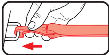
**4. Tensione las correas de anclaje inferiores**
